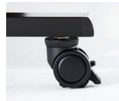
アジャスト機能付リフトロックキャスター キャスター上部のリングにより高さ 調節できます。
